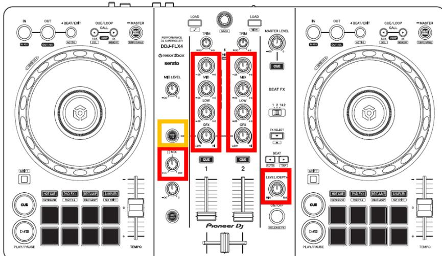
調整対象ノブ：EQノブ,CFXノブ,LEVEL/DEPTHノブ,Ω MIXノブ 計 10箇所
