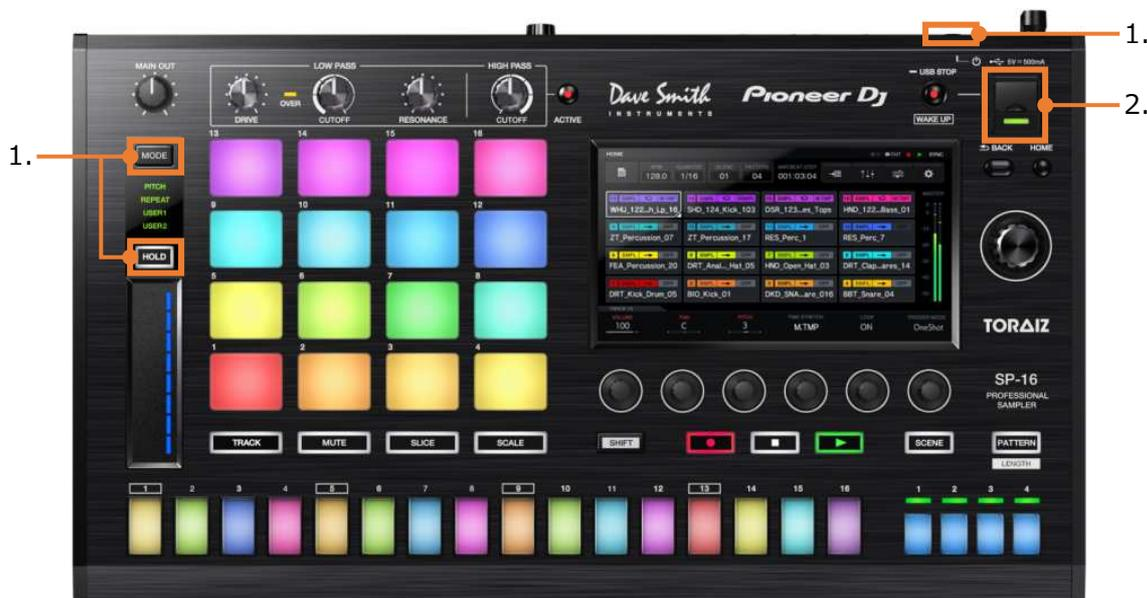
1. 電源が OFF の状態で、USB メモリ、LINK 接続及びコンピューターとの接続を外し、MODE ボタンと HOLD ボタンを同時に押しながら電源を ON してください。「Connect USB storage device into top USB slot.」のメッセージが表示されますので、ボタンから手を離してください。
